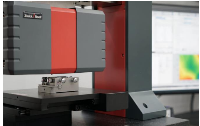
Detailansicht mit Probenhalter und Messkopf
