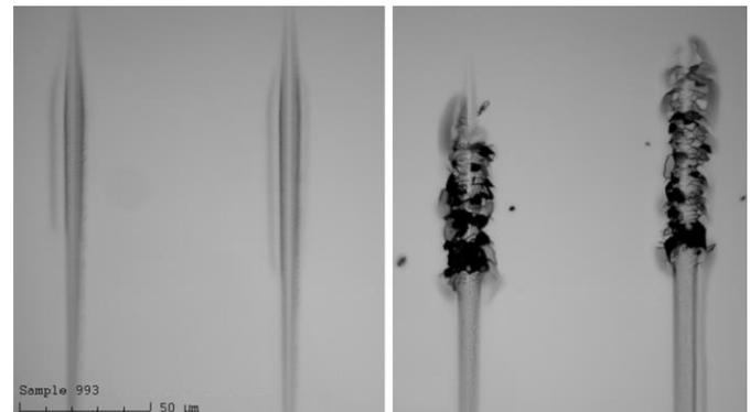
Scratchspuren in einer rund 300nm dünne Mo-Schicht auf Glas. Ohne Oszillation löst sich die Schicht nicht ab (linkes Bild) während sich die Schicht mit Oszillation reproduzierbar ablösen lässt.
