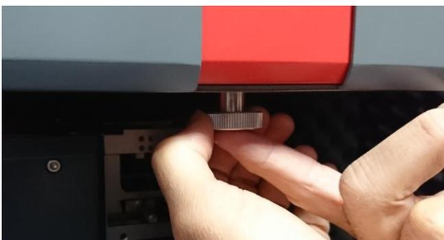
Werkzeug zum Spitzenwechsel ohne zusätzliche Schutzmaßnahmen
